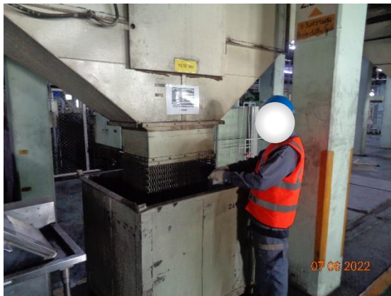
ทรายเสียจากการทำไส้แบบตัวอย่างที่ 3 (TCM 011) @ Casting 1 (Sand Recycle)
